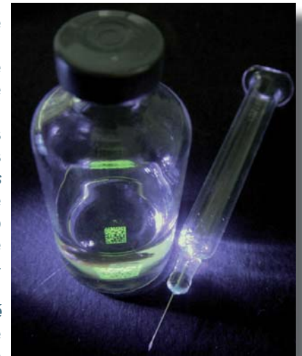
Datamatrix Glass'in visible sous UV
